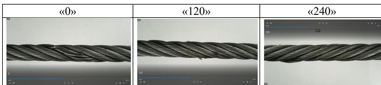
2.5.4. Фрагмент видеопотока конкретного дефекта «2 - наружный износ проволоки» на поверхности стального каната, съемка которого производилась при фиксированном угле поворота «0», «120», «240» относительно оси каната ГОСТ 2688-80, диаметром 16,5 мм
