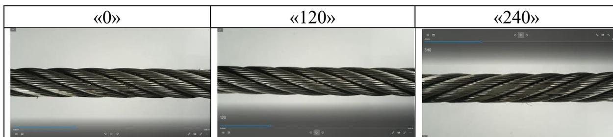
2.5.5. Фрагмент видеопотока конкретного дефекта «3 - местное увеличение или уменьшение диаметра каната» на поверхности стального каната, съемка которого производилась при фиксированном угле поворота «0», «120», «240» относительно оси каната ГОСТ 2688-80, диаметром 16,5 мм
